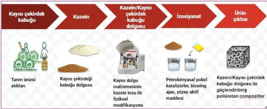
Şekil 2. Kayısı çekirdek kabuğundan poliüretan üretim aşamaları (Czlonka et al., 2021; Al-Soufi et al., 2022).
