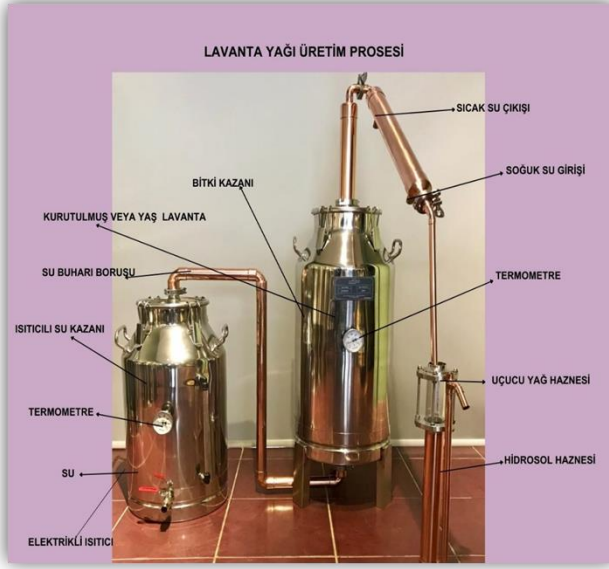
Şekil 2.1. Su buharı distilasyon cihazı (İğdır Üniversitesi Kozmetik Atölyesi)
