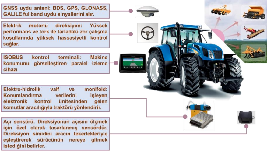
Şekil 14. Tarım traktörlerinde kullanılan akıllı sistemler (Fotoğraf: www.newholland.com)
