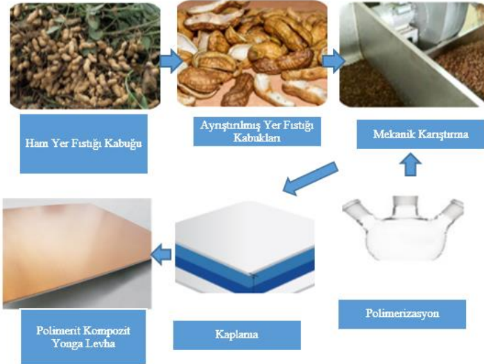
Şekil 5. Yer fıstığından “Polimerit Kompozit Yonga Levha” üretim aşamaları (Karabulut, 2022).
