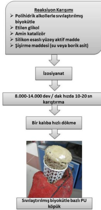
Şekil 31. Sıvılaştırılmış biyokütleden PU köpük üretimi (Alma ve ark., 2021)
