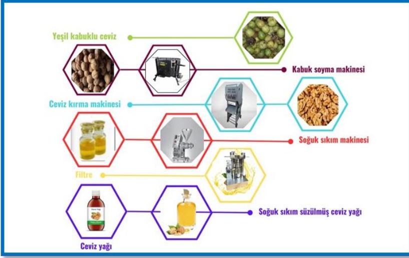
Şekil 3. Cevizde soğuk yağ çıkarma işleminin grafik gösterimi (Massoodi ve ark., 2022)
