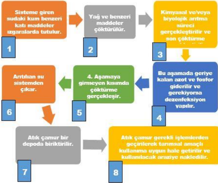
Şekil 3. Arıtma çamurlarının arıtma süreci (Anonim, 2017)
