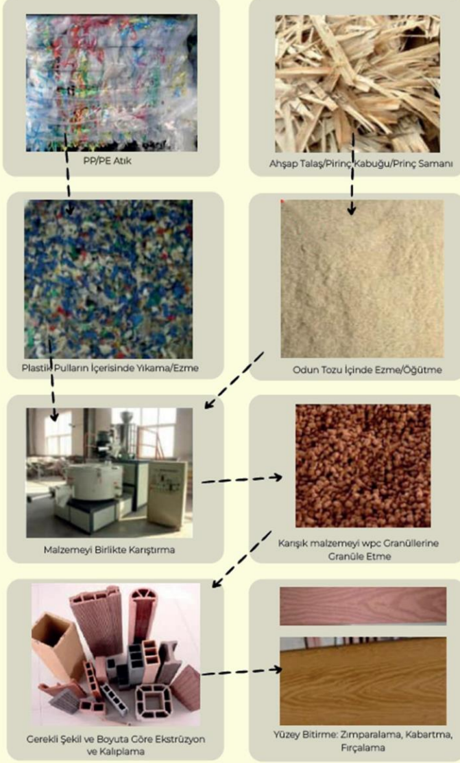
Şekil 10. Ayçiçeği gövdesinden PP/PE WPC üretim süreci
