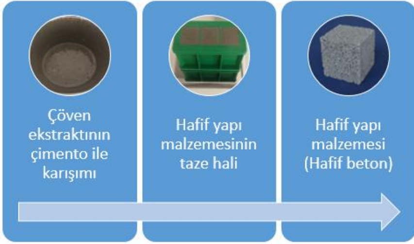
Şekil 2. Çöven bitkisinin hafif yapı malzemesinde kullanımı
