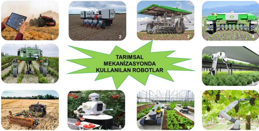
Şekil 16. Tarımsal mekanizasyonda kullanılan bazı otonom robotlar. Fotoğraflar; 1: otonom traktör ( www.lifewire.com ), 2: ekim robotu ( www.futurefarming.com ), 3: güneş enerjili dikim robotu ( www.thwhite.com ), 4: bakım-çapalama robotu ( www.naio-technologies.com ), 5: yabancı ot temizleme robotu ( https://geneticliteracyproject.org ), 6: İlaçlama robotu ( www.foodunfolded.com ), 7: toprak işleme robotu ( www.amazon.net ), 8: Domates hasat robotu (Jia vd., 2020), 9: Sebze hasat robotu ( www.howtorobot.com ), 10: Üzüm hasat robotu ( http://news.foodmate.com ).
