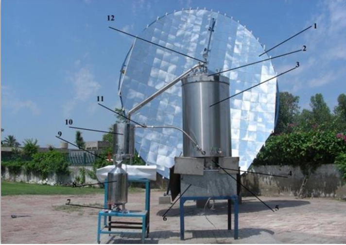
Şekil 16. Güneş distilasyonu ünitesi (Afzal et al., 2017). 1- Birincil reflektör, 2- Distilasyon imbiki üst kapağı, 3- Distilasyon imbik, 4- su çıkışı, 5- su seviye göstergesi, 6- İkincil reflektör, 7- gelen hidrosol için çıkış Florentine matara, 8- Florentine matara, 9- su girişi kondenser, 10- Kondenser, 11- Sıcak su çıkışı kondenseri, 12- Basınç göstergeleri
