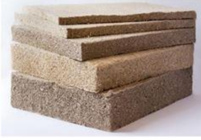
Şekil 2. Kenevirden üretilmiş yalıtım malzemesi ve kenevir tuğla (Gizlenci ve ark., 2019)
